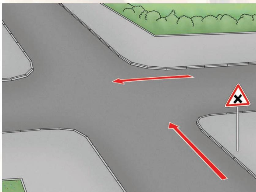
Нерегулируемый перекресток – перекресток, на котором отсутствуют светофоры, светофоры не работают или работает только желтый мигающий сигнал светофора, отсутствует регулировщик.
