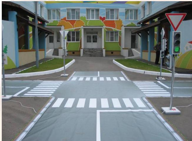
Основное достоинство мобильного автогородка – возможность эксплуатации практически на любой ровной поверхности (при наличии достаточной площади). При этом развертывание, установка и подключение оборудования занимает считанные минуты и совсем не требует специальных навыков. Мобильный автогородок заинтересует прежде всего учебные учреждения и частных заказчиков, не имеющих обособленной асфальтированной площадки или проводящих выездные учебно-методические мероприятия по изучению ПДД.
